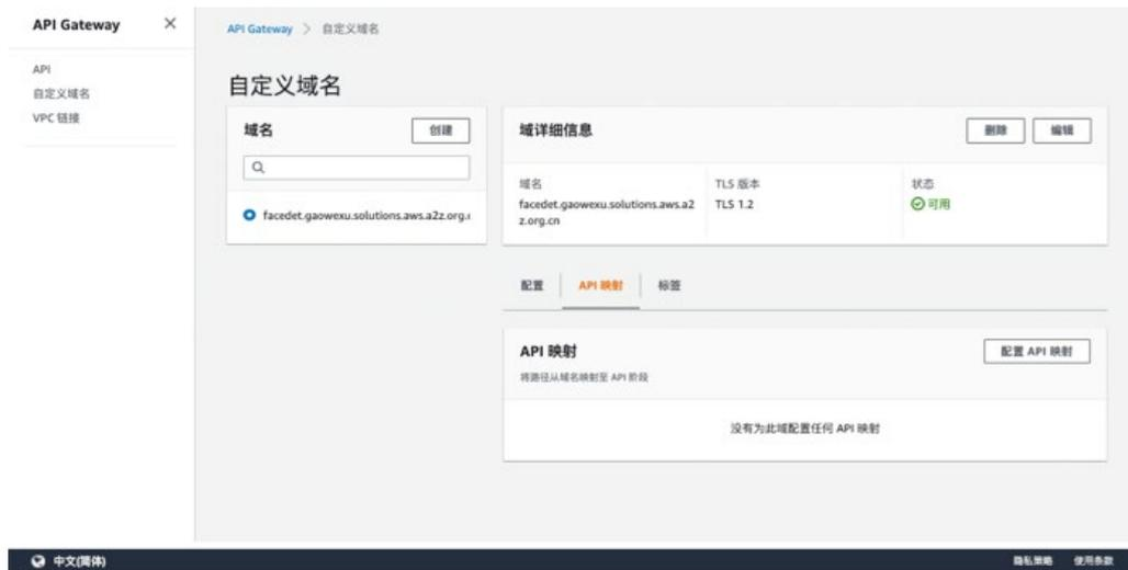
点击【配置 API 映射】-【添加新映射】，选择对应的 API，阶段，路径保持不变，无需填任何值，点击【保存】，如下图所示：
