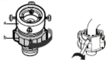
4. 按住滑动器c，将进水管与接头连接，松开c部分使其自动接合；发出‘咔’声表明已自动接合。
