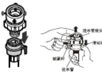
2. 首先使用十字起子松开四个螺丝，然后把螺母b部分按箭头方向转，转至距离连接器a部分约5毫米。
