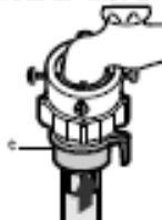
5. 以顺时针方向将进水管的另一端拧紧在洗衣机进水口上。
