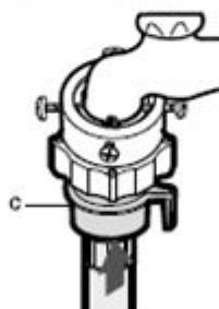
5. 以顺时针方向将进水管的另一端拧紧在洗衣机进水口上。
