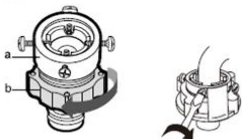
4. 按住滑动器c，将进水管与接头连接，松开c部分使其自动接合；发出‘咔嗒’声表明已自动接合。
