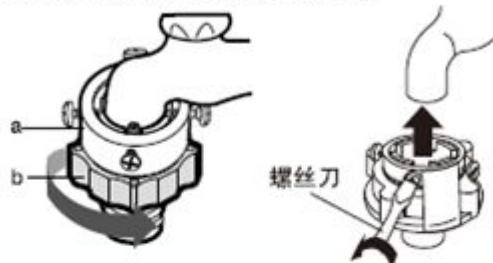
3. 连接器套上水龙头向上与水龙头靠紧后，用螺丝锁紧，再转螺母b部分使ab合并。
