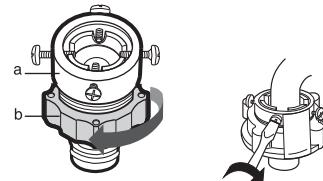
4. 按住滑动器c，将进水管与接头连接，松开c部分使其自动接合；发出‘咔嗒’声表明已自动接合。
