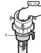
5. 以顺时针方向将进水管的另一端拧紧在洗衣机进水口上。
