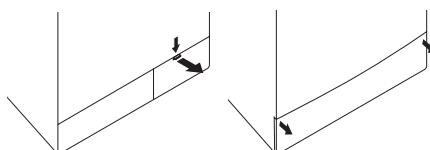
2. 根据您的洗衣机型号，过滤器盖可以由一个或两个零件组成。如果由两个零件组成，则可以向下按过滤器盖上的凸钮，并向外拔出。如果过滤器盖由一个零件组成，捏住两侧向外拉就可以打开。
