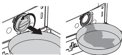
4. 松开排水泵过滤器（逆时针），直到有水开始从过滤器中流出。直接将水排入您放置到过滤器前方的容器中。您可以使用抹布吸收溅出的水。
