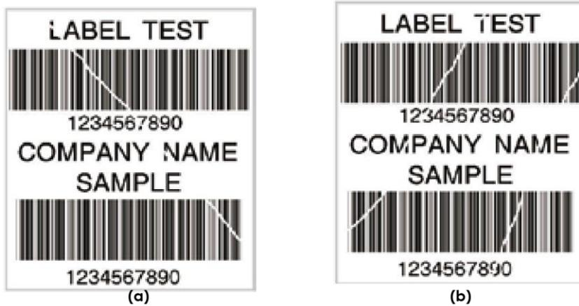
调整圈数每次以半圈为一个单位调整，调整后请再作打印测试，如碳带褶皱未改善，请依上述方式再作调整，而调整圈数不得超过 2 圈(即调整次数为 4 次)。
