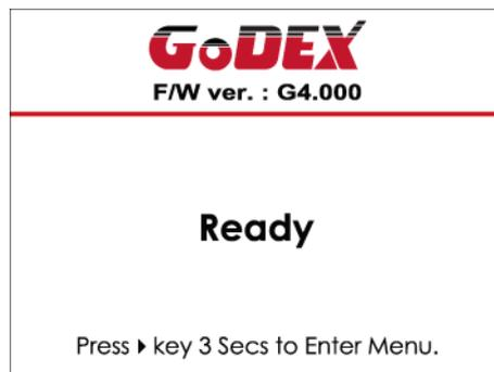
请按住 ▶ 按钮，待 LCD 屏幕上的定时器到数完成后，即可进入设定模式的主画面
