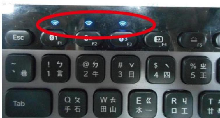
步骤 3. 当蓝牙键盘和打印机建立联机时，蓝牙键盘上蓝灯不在闪烁(如红圈所示)
