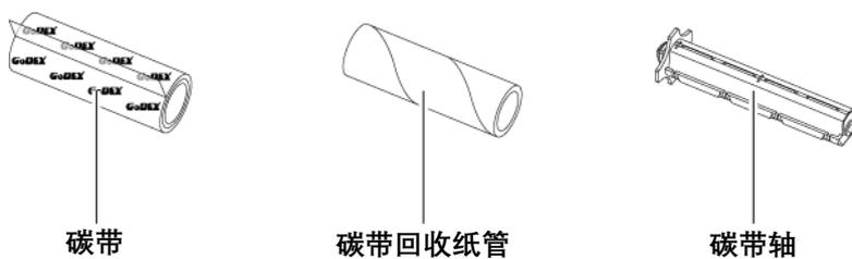
1. 将新碳带开端的自黏胶部份对齐贴在碳带回收纸管上
