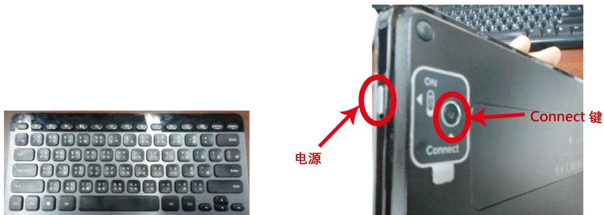
步骤 1. 开启蓝牙键盘的电源后，按下“Connect”键，使打印机可搜寻到蓝牙键盘
