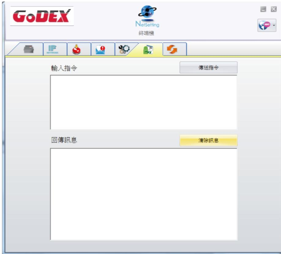
按下“传送指令”键可以将打印机命令经由网络传送到打印机，藉此实现远程操作功能。
