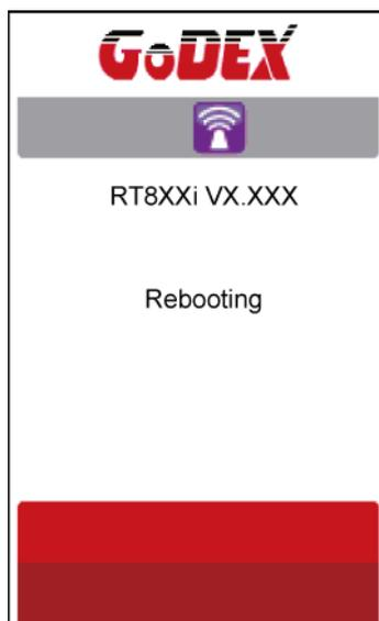
步骤 12. 当打印机重新启动后，Wi-Fi 图标会变成紫色，即无线网络模块成功连上基地台
