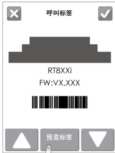
在呼叫标签页面可查看条形码机内部所有的标签，处理的时间会随着档案数量越多而增加。
