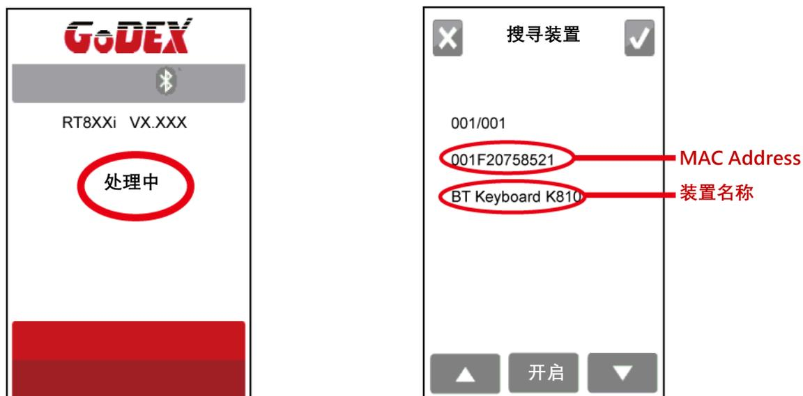
步骤7. 待面板显示蓝牙键盘信息后，轻压下方“开启”键使打印机和蓝牙键盘建立联机，此时面板显示“请输入PIN码”，从蓝牙键盘上将“PIN Code”输入至打印机内
