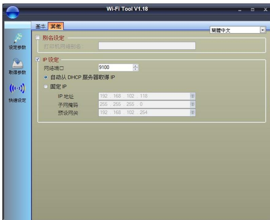
13. 进入到“卷标打印输出接口”，填入IP地址后点击确认即完成设定。
