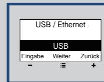
**Schritt 3** ▶ Wählen Sie Ethernet aus, indem Sie FEED -> PAUSE -> FEED betätigen.
