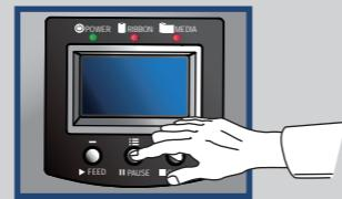
**Schritt 2** ▶ Nun drücken Sie den PAUSE-Button bis zum Menüpunkt USB /Ethernet
